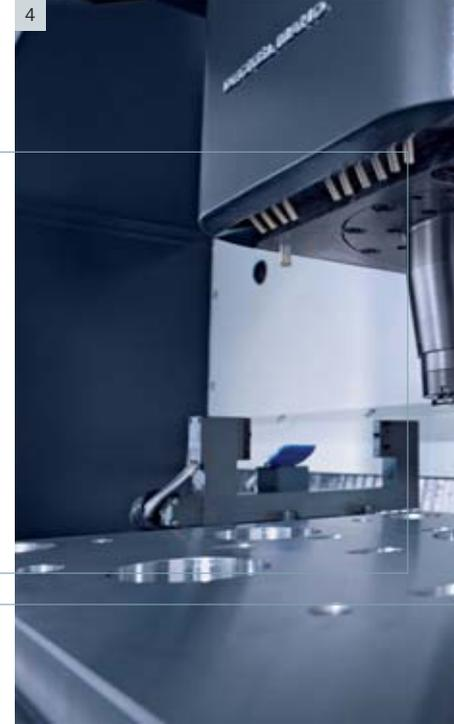
1| Leistungsstarke 10.000er-Motorspindel 2| 20er-Werkzeugmagazin 3| DMG ERGOline® Control mit 19"-Bildschirm 4| Großer Arbeitsraum für Werkstücke bis 1.000 kg (DMC 1035 V) 5| Schneller Doppelgreifer
